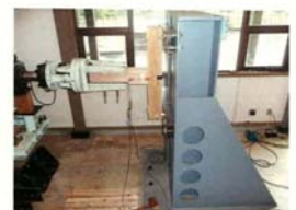
試験状況(込み栓-水平)
