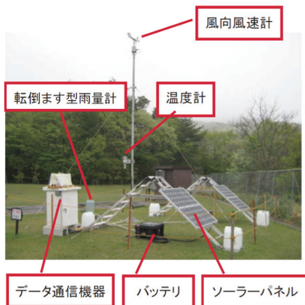
可搬型気象計の概要（女川アメダス観測所）
