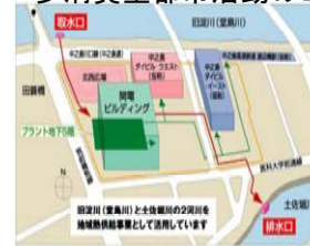
河川水温度差エネルギー利用
