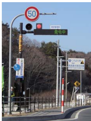
津波浸水想定区域には、以前から津波標識を設置していた。昨年2月、先行的に宮古市で「津波警報板」を設置し始めたその約2週間後に地震が発生。「津波警報」が発令された時に、通行中のドライバーや歩行者にその情報を即時に提供し、自主的な避難を促すことが重要。津波警報板の整備を進めています（波邊）
