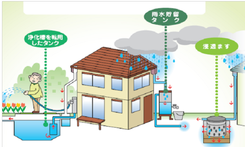
雨水貯留浸透施設(浄化槽の転用) 出典:愛知県の下水道HP
