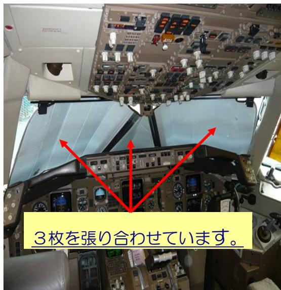
駐機中における客室内は、シェードをクローズすることにより一定度の機内温度の上昇抑制が可能となっていますが、コックピットは、日照と機器類から発せられる熱で大変な暑さになってしまうため、左写真のような手作りサンシェードを利用することにより、コックピットの気温上昇を防ぎ、従来必要だった機内空調時間の短縮及びその機内空調のために必要な燃料削減（CO<sub>2</sub>削減）を図っています。
