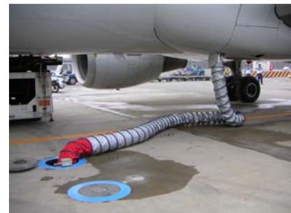
GPU による航空機への冷暖房の供給
