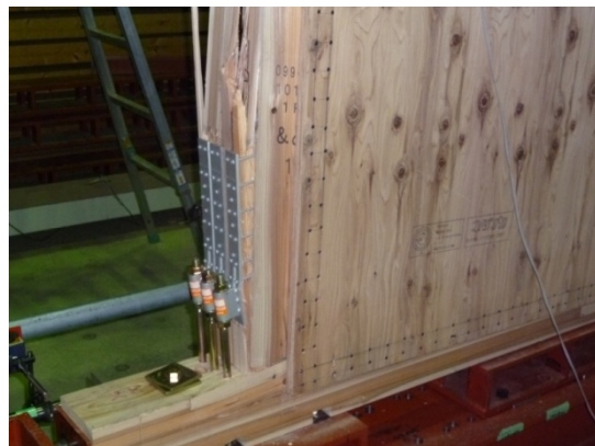
写真13 No.⑤の破壊（柱の曲げ破壊と ビス接合部の集合型破壊）
