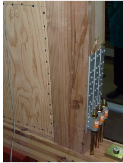
写真17 No.⑨の破壊 (柱の曲げ破壊)
