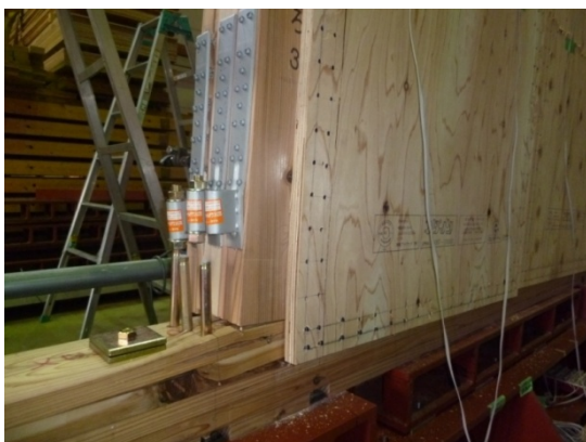
写真7 No.②の破壊 (ボルト破断と土台の割裂)
