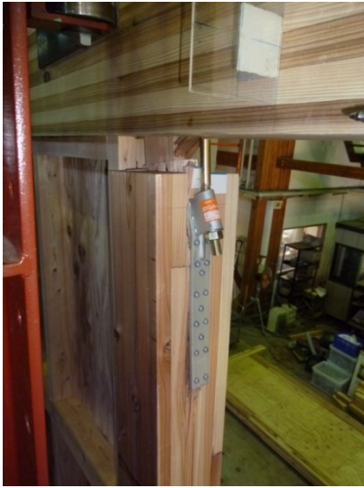
写真16 No.⑧の破壊 (ほぞの破壊)
