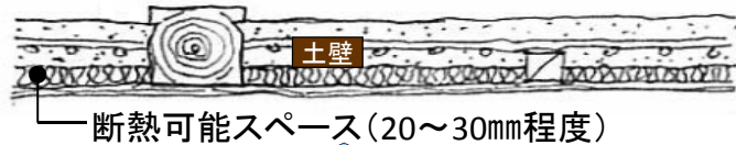
(土壁の住宅の外壁の構造の例)
