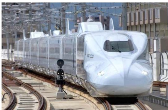
九州新幹線N700系「みずほ」。従来の700系を土台に高速性と快適性・環境性能向上を図った第二世代の車両(初代0系新幹線対比電力消費量は32%低減。)
