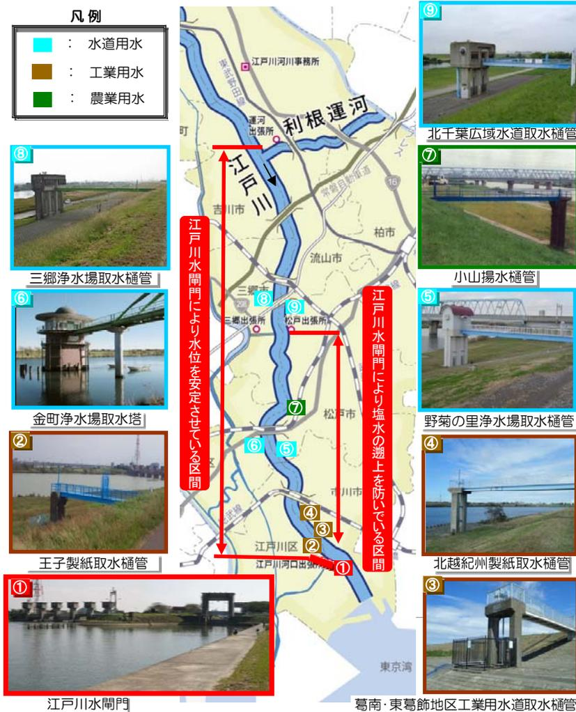
江戸川水閘門は、昭和18年に完成し施設を維持管理しながら運用を行ってきたが、ゲートの腐食などに対応するため、土木構造物の健全性を確認し、大規模改築を実施することなく部分改築(昭和46年)及び部品の交換・修理で現在まで運用を図っている。
