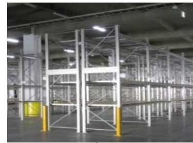
・アンカーボルトによるラックの固定
