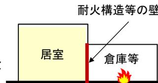
※1) 区画を構成する床や壁等に接する外壁は、開口部を介して外部で区画から区画へ延焼するおそれがあるため、その部分を含み幅90cm以上の部分を準耐火構造とし、又は50cm以上突出した準耐火構造のひさし等を設ける。
