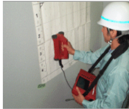
鉄筋探査の例 (電磁誘導法)
