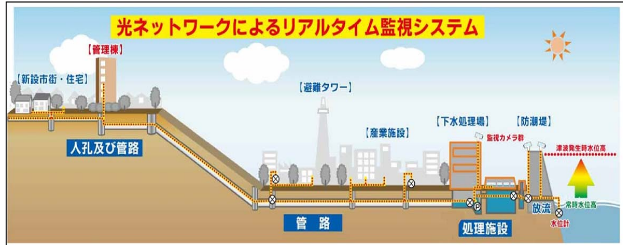
管理棟の高台移転と施設の遠隔操作
