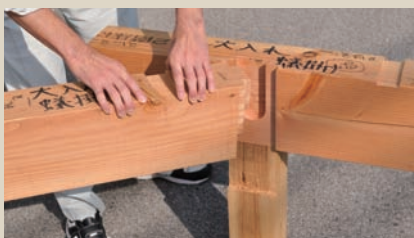
上段／車庫の屋根を支える柱・梁には、強度の高い岡山県産の欧州赤松を使用。右／木材に取り付けた車庫シャッター用の金属製レール。下段／接合部の正確さを確認するため、事前に製作した原寸サンプル。
