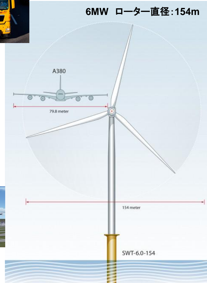
6MW洋上風車とエアバスA380
