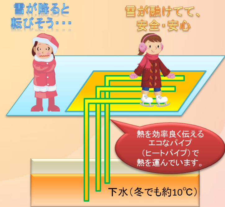
ヒートパイプの熱輸送原理
