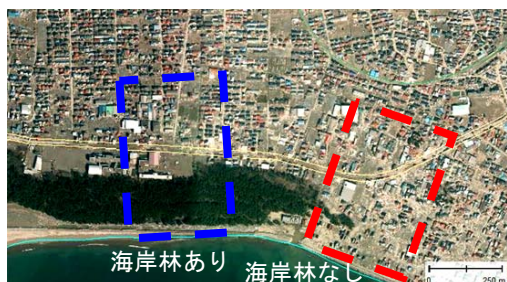
図 I-7 樹林の有無による流出家屋状況の差異（石巻市長浜地区） 出典：国土地理院 空中写真（平成 23 年 3 月）より作成
