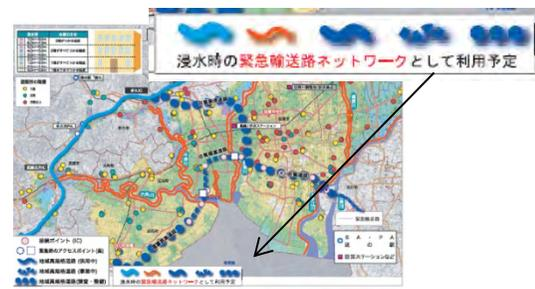
地域高規格道路と河川堤防の接続による広域応援・緊急輸送ネットワークの構築
