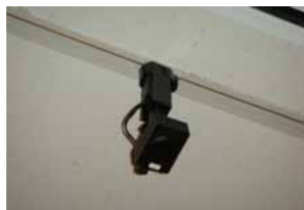
太陽光パネルを設置した電波マーカ(左)と、天井に架設された電源レールに取り付けた赤外線マーカの事例(平成22年度津和野地区)
