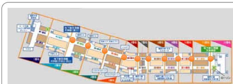
Wi-Fi 基地局を地下通路の分岐点であり地下街の区画の境界部となる箇所に設置した事例(平成 22 年度福岡地区)
