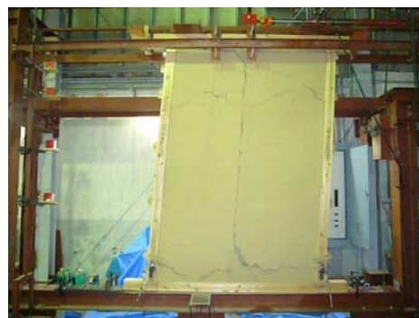
写真 1-13 金沢仕様の土壁の構造的特性を把握するための実験（金沢工大 後藤研究室実施）
