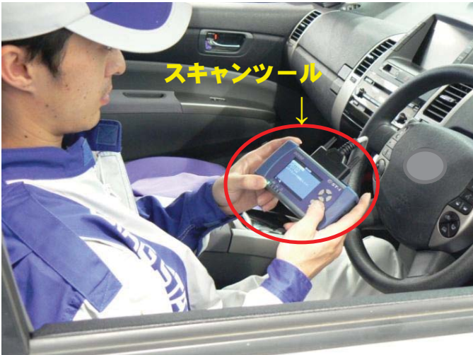
スキャンツールとその診断作業風景
