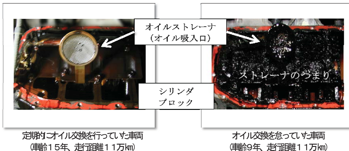
図1 使用過程車のエンジン内部の比較
