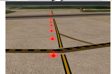
パイロット席から見たときの警告状態
