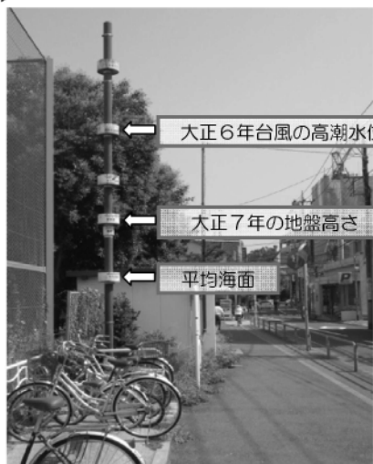
地盤沈下の状況(東京都江東区)
