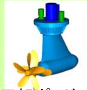
二重反転ポッドプロペラ (高い操船性能等)
