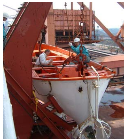
PSCの現場(救命艇の確認)
