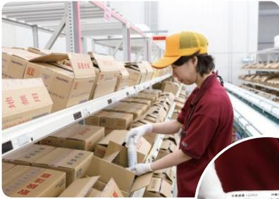
3階の荷揃えエリア。専用端末から荷揃え用のラベルが発行されると、同時に該当商品が置かれている棚に赤いランプが付く。それに合わせて専門の作業員が手作業で品物を揃えていく。
