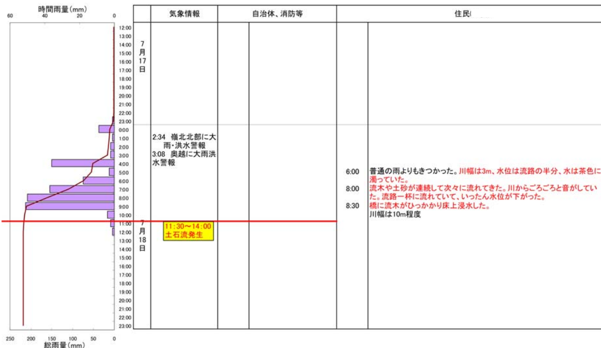
板垣(アメダス) 前兆現象及び警戒避難状況整理表(福井県今立町水間地区岩窟谷川)
