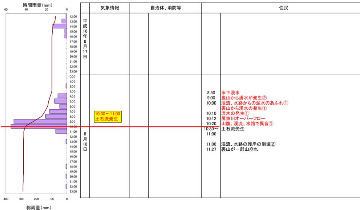
前兆現象及び警戒避難状況整理表(愛媛県新居浜市又野川)
