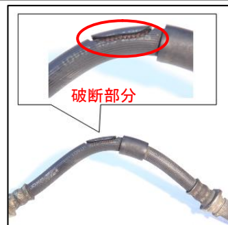
<ブレーキホースの破断事例>
