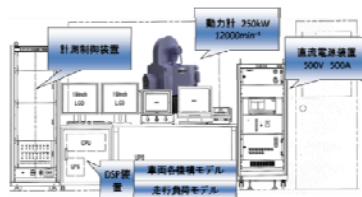
ハイブリッド台上試験システム 高効率ハイブリッドトラック
