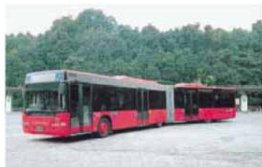
図 1-2-8 全長 18m のノンステップ連結バス「ツインライナー」
