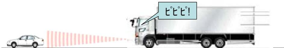
ドライバーが停止車両に気づかない場合は、音によりドライバーにブレーキ操作を行うように促す。
