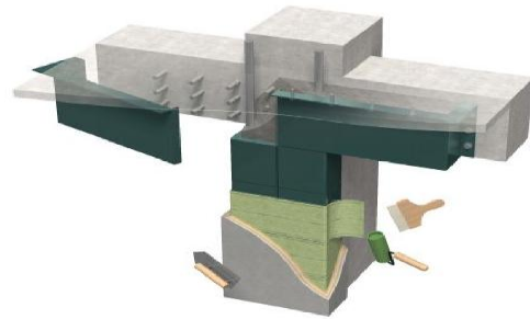
図1.1 鋼板の積層と繊維シートの貼付け
