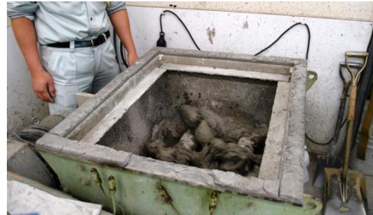
シラスコンクリートの試験練り
