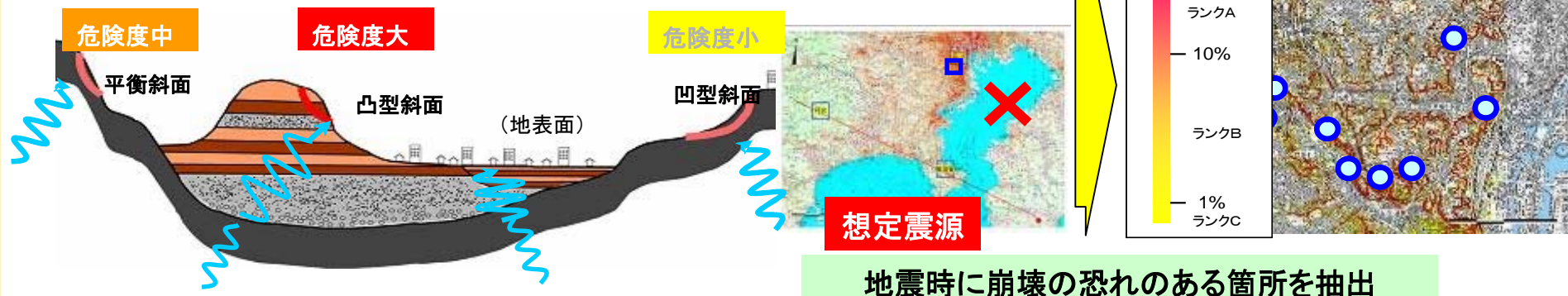
新たな地震時崩壊危険度評価システムにより崩壊危険度評価
