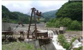
掃流砂量の観測及びサンプリング
