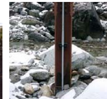
砂面計を用いた地形測量
