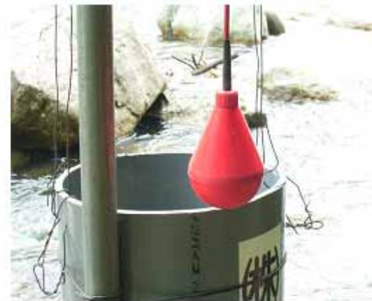
図 施工現場2.5km上流に設置した水位警報装置
