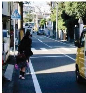
<歩行の支障となる電柱>
