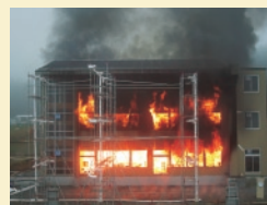
木造3階建て校舎の火災実験の様子
