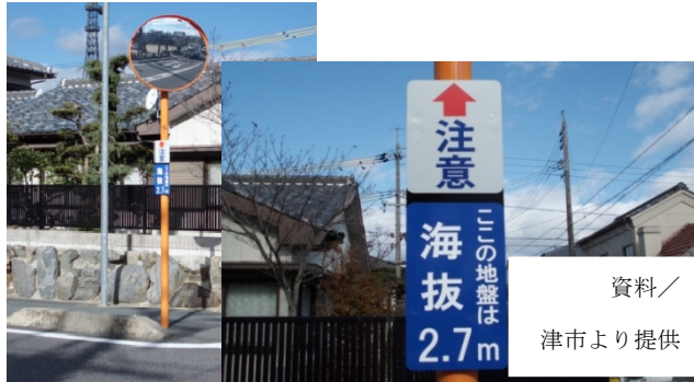
カーブミラーへの海拔表示の設置 [事例2-14より]
