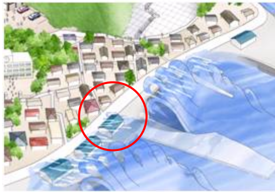
津波に対する道路盛土の二線堤化
