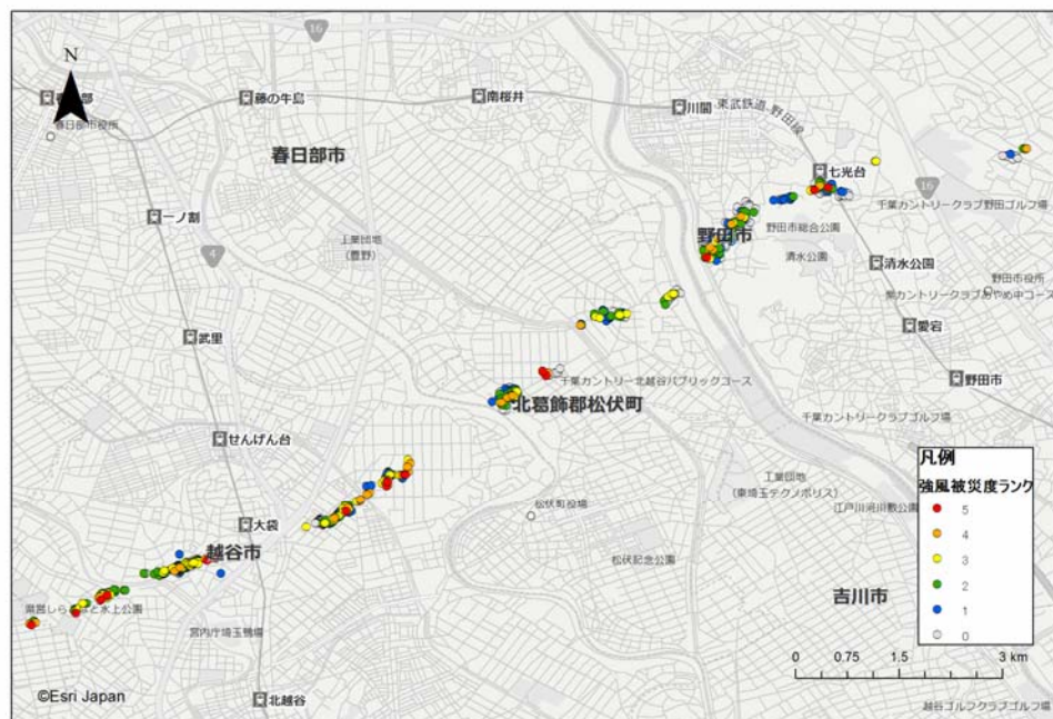
図 1.2 強風被災度ランクによる被害分布（当初調査＋追加調査）
