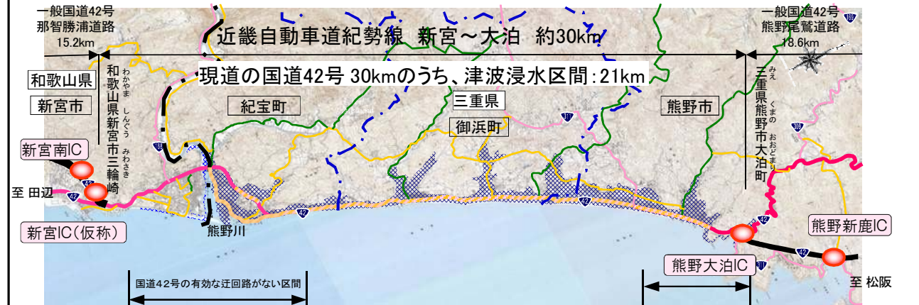
図5 津波浸水区域を通過する国道42号
