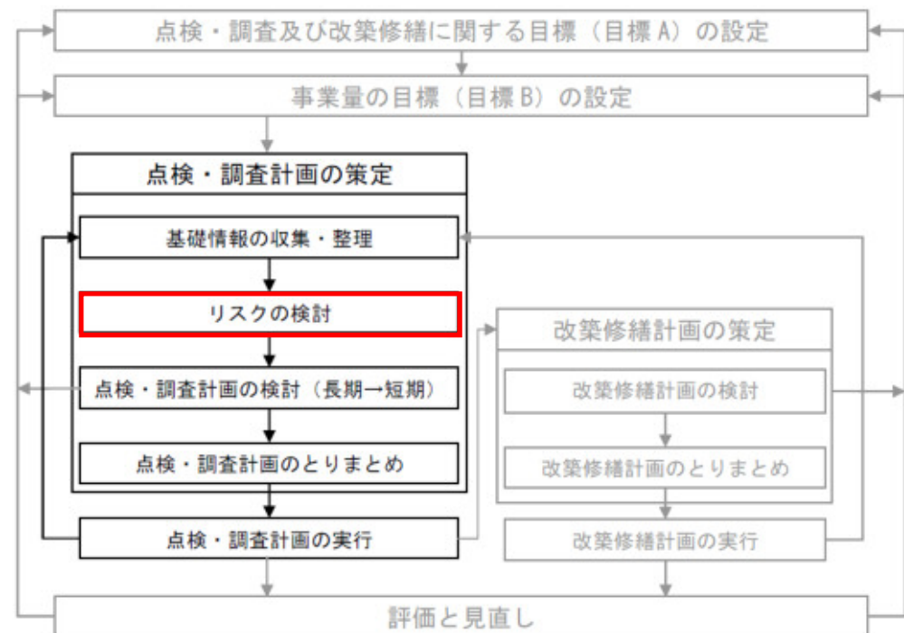
リスク評価を組み込んだ点検・調査計画の実施手順の例 (「下水道施設ストックマネジメント手法に関する手引き(H23.9)」p19)
