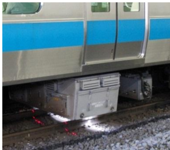
【線路設備モニタリング装置】
