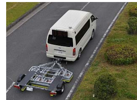
道路空洞化調査
