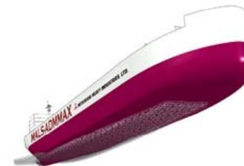
【新型ばら積み運搬船 空気潤滑システム稼動時の船底】
