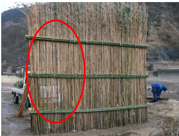
写真 3-2 延焼防止を検証するための構造(Aタイプ)
