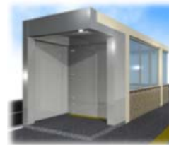
浸水深に応じた出入口整備(腰壁嵩上げ等)
