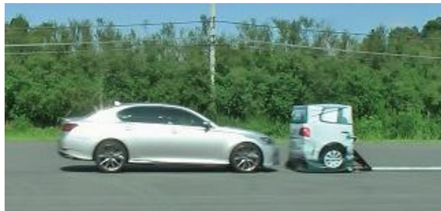
AEB対車両テスト （自動運転装置と試験用ターゲット）
