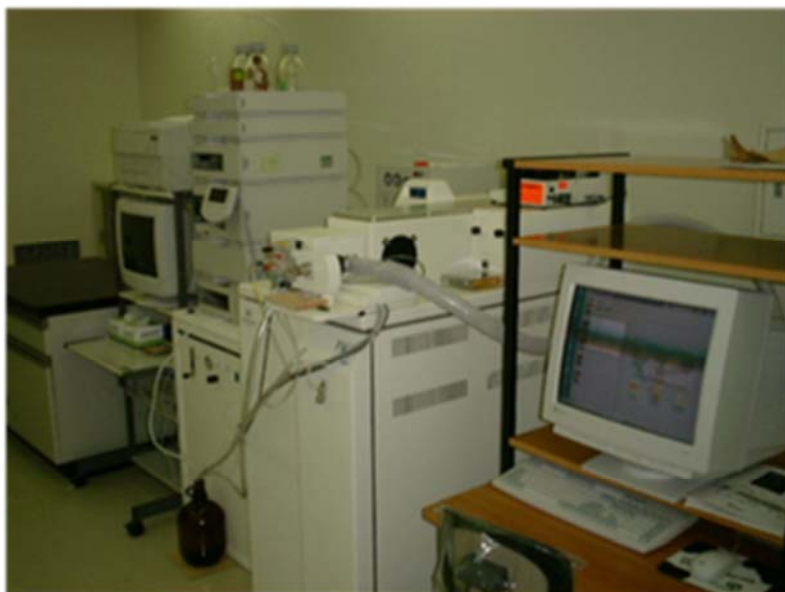
図 4. 208 河川での水質事故を検出する毒物検知バイオセンサ
