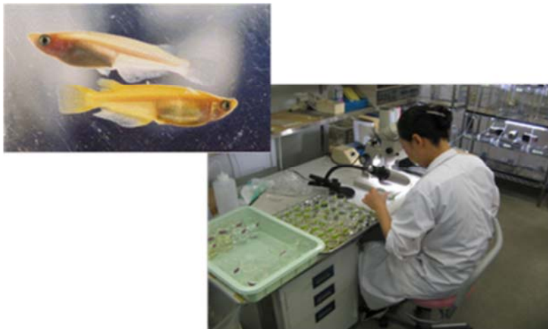
図 4.216 メダカ受精卵による生物応答試験(WET)
