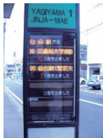
バスロケーションシステム
